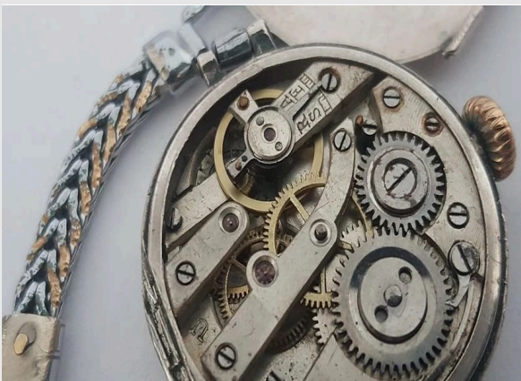
Las ruedas dentadas de un reloj mecánico.
