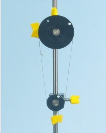
Configuración del experimento de la transmisión por correa
